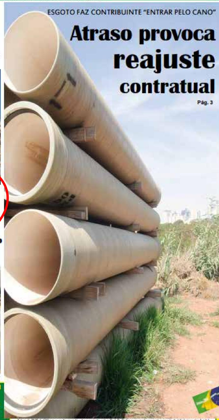
Tubos de PVC de 500mm que vão permitir a transposição sob a Rod. D. Pedro e por onde escorrerá o esgoto de Itá (fonte)
